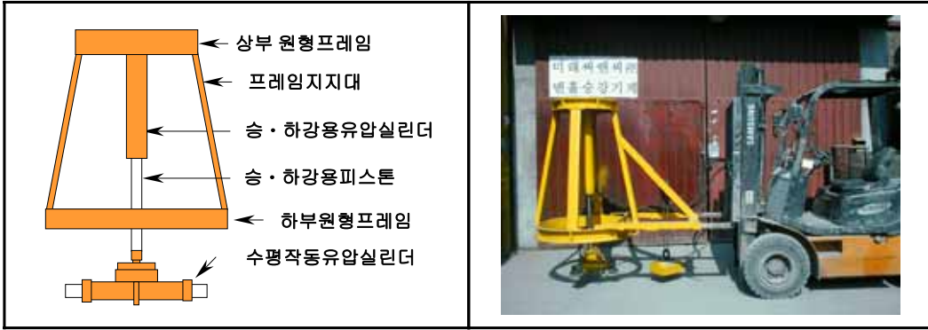
그림 1.1. 비굴착식 승강형 맨홀보수기계장치 전경
