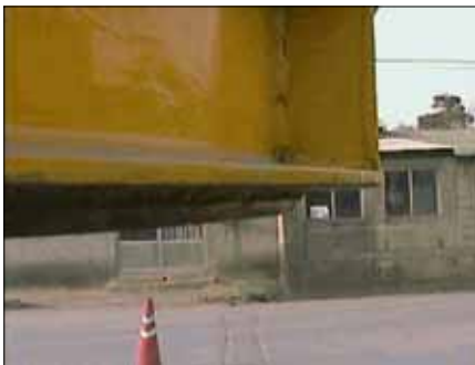
사진 1.3 원형하부프레임에 설치된 V자형 칼날
