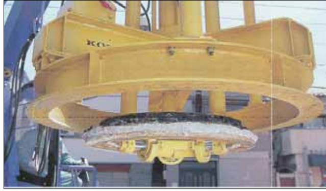
사진 1.13 MR 2 공법의 맨홀틀 제거 승강방법
